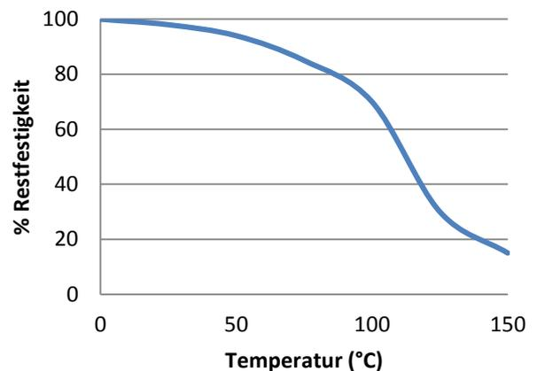
„Hitzebeständige“ Scherfestigkeitsversuche wurden auf Glas auf Weichstahl Klebeverbindungen durchgeführt. Vor den Testversuchen wurden die Teile über 30 Minuten auf der Testtemperatur gehalten. UV605 kann bei geringen Belastungen kurzzeitig auch höheren Temperaturen ausgesetzt werden (z.B. bei Einbrennlack- oder Schwall-Löt-Verfahren). Niedrigste Temperatur bei Endfestigkeit: -55°C (abhängig von den verwendeten Materialien).
