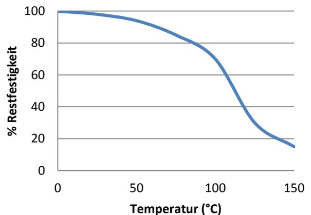
„Hitzebeständige“ Scherfestigkeitsversuche wurden auf Glas auf Weichstahl Klebeverbindungen durchgeführt. Vor den Testversuchen wurden die Teile über 30 Minuten auf der Testtemperatur gehalten. UV670 kann bei geringen Belastungen kurzzeitig auch höheren Temperaturen ausgesetzt werden (z.B. bei Einbrennlack- oder Schwall-Löt-Verfahren). Niedrigste Temperatur bei Endfestigkeit: -55°C (abhängig von den verwendeten Materialien).
