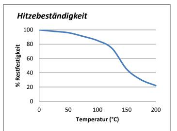
"Hitzebeständige" Scherfestigkeitsversuche wurden auf Weichstahl durchgeführt. Vor den Testversuchen wurden die Teile über 30 Minuten auf der Testtemperatur gehalten.
