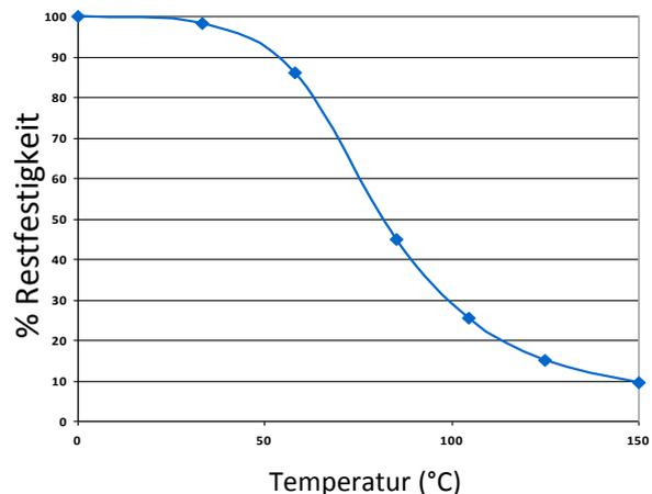
MT3821 kann bei geringen Belastungen kurzzeitig auch höheren Temperaturen ausgesetzt werden (z.B. bei Einbrennlack- oder Schwall-Löt-Verfahren). Niedrigste Temperatur bei Endfestigkeit: -40°C (abhängig von den verwendeten Materialien).
