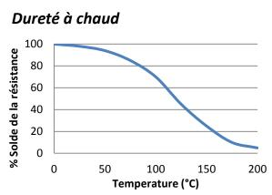
Essais de cisaillement en température réalisés sur l'acier doux. Polymérisation complète à température ambiante, puis mise en température durant 30 minutes avant réalisation des essais.
