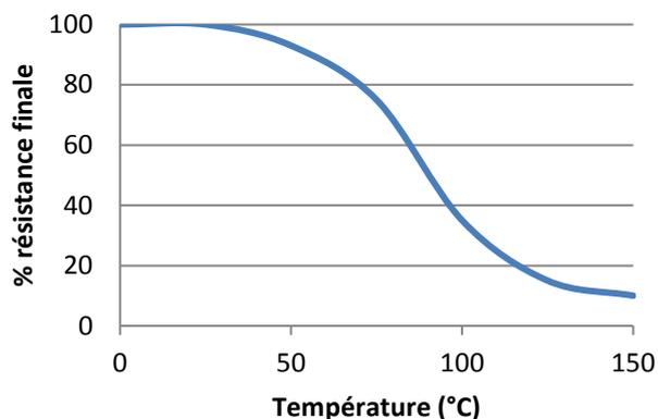
Tests de résistance au cisaillement à des températures élevées sur acier doux.
