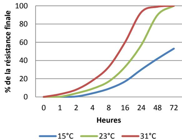
Ce graphique montre un développement typique de la résistance des composants collés. Une augmentation de la température de 8° réduira de moitié le temps de polymérisation. Plus les températures sont basses, plus le temps de polymérisation est long.
